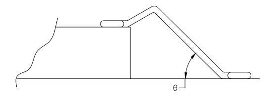
FIGURE 2011-3. Wire loop angle.
