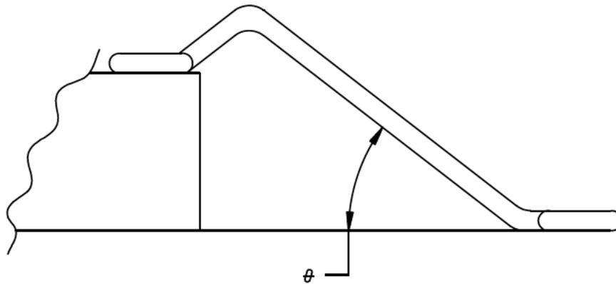
FIGURE 2023-2. Wire loop angle.
