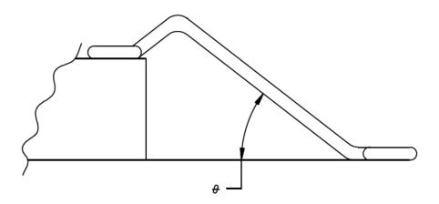
FIGURE 2023-2. Wire loop angle.
