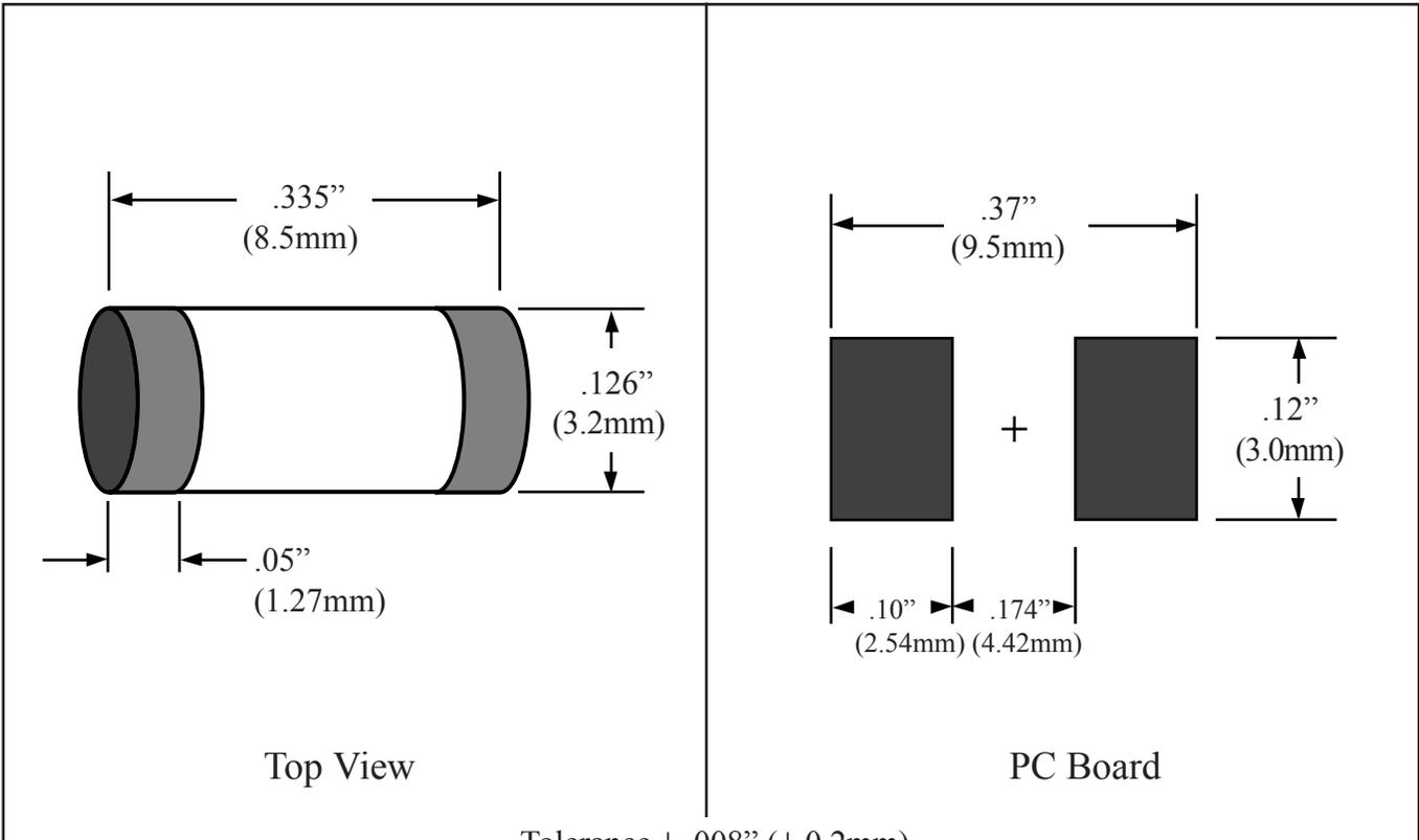
Tolerance  $\pm .008''$  ( $\pm 0.2\text{mm}$ )
